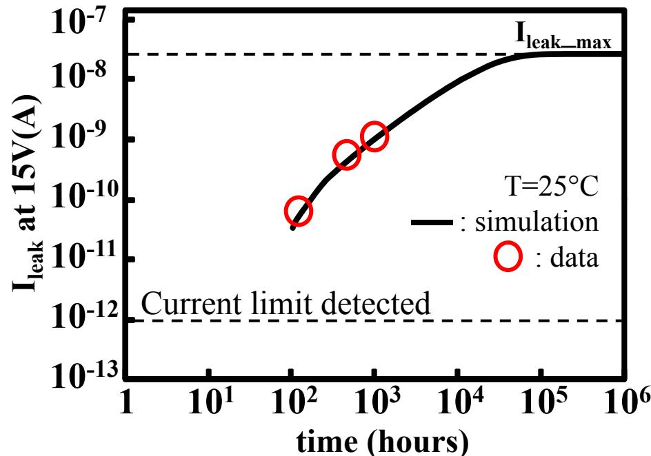
$$I_{leak} = I_{leak\_max} \times \left(1 - e^{-\left(\frac{t-t_0}{k}\right)}\right)$$
